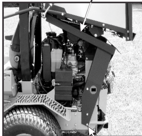
(3) 3/8"-16 x 1" HHCS (3) 3/8"-16 Flange Nuts Per Leg.
